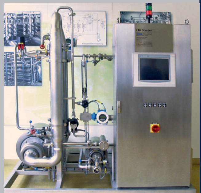
Pilotanlage Mikrofiltration Pilot plant Mikrofiltration
