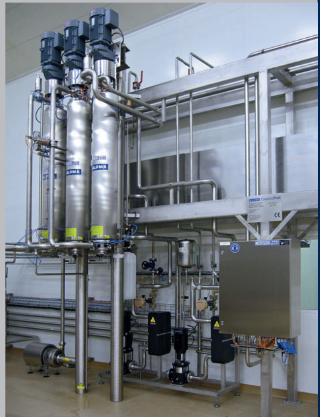
CreamoProt®-Anlage zur Partikulierung von Molkeproteinkonzentrat.
